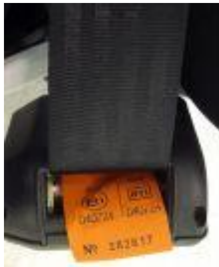
Fig. 57 - cintura di sicurezza con etichetta di certificazione
