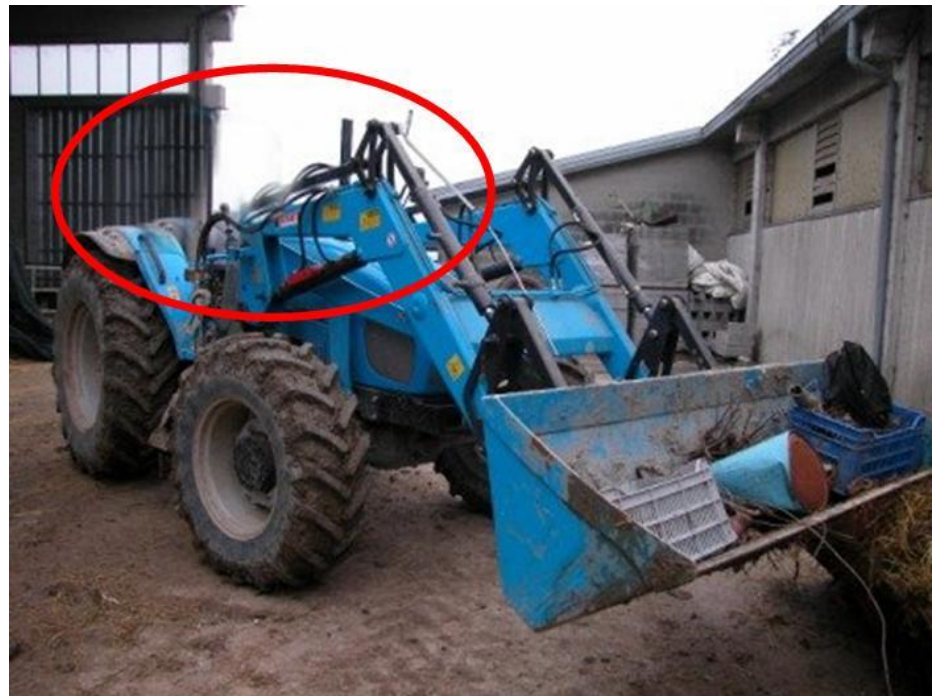
Fig. 54 - trattore nuova senza telaio antiribaltamento
