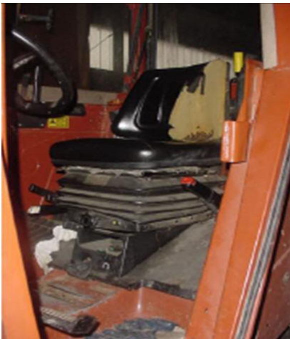
Fig. 77 - sedili senza attacchi
