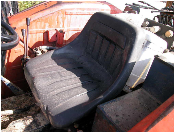
Figg. 66 e 67- sedili fissi senza attacchi per le cinture di sicurezza
