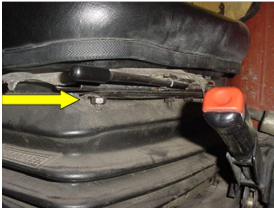
Fig. 78 - bulloni esistenti per il collegamento del sedile
