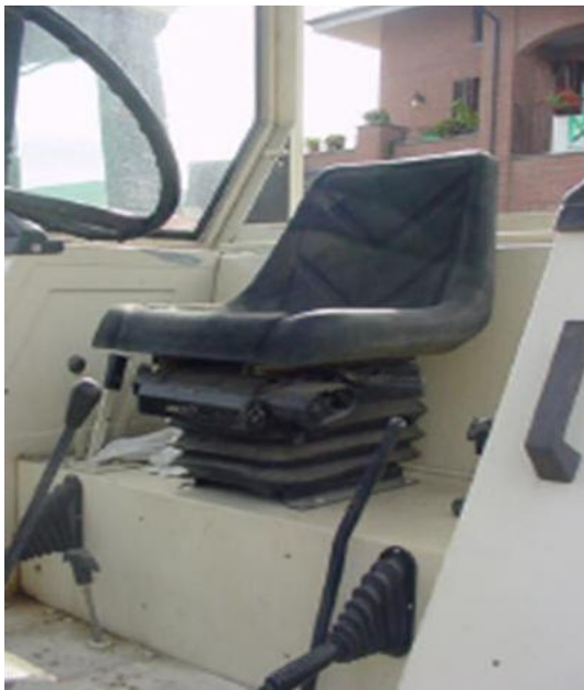
Fig. 77 - sedili senza attacchi
