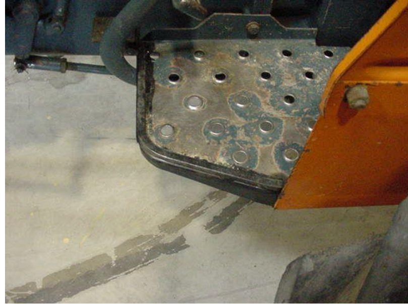
stessa pedana alla quale è stato applicato sul bordo un profilo a sezione quadrata che evita lo scivolamento nella fase di salita e discesa dalla trattrice
