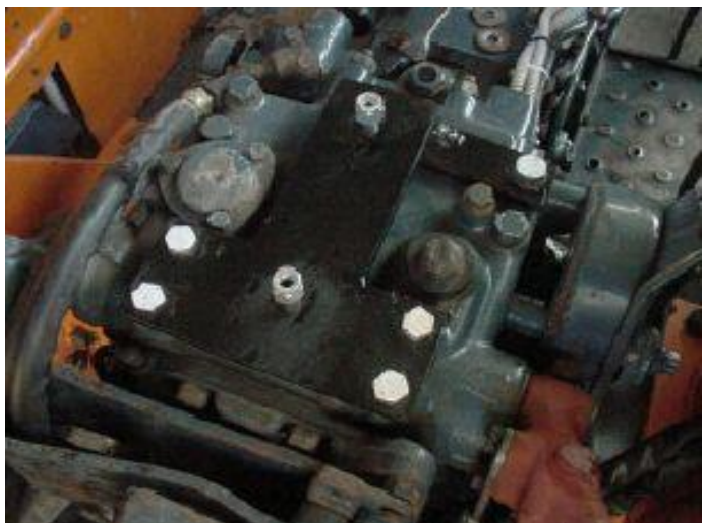
piastra di collegamento installata sul basamento della trattrice (mm 80x200x4)
