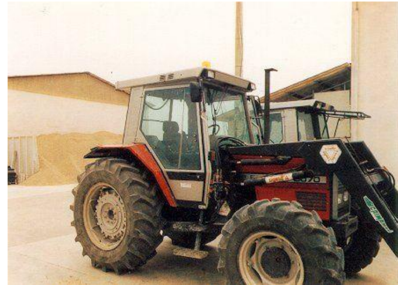
Fig. 30 - trattore con cabina integrata con sistema ROPS
