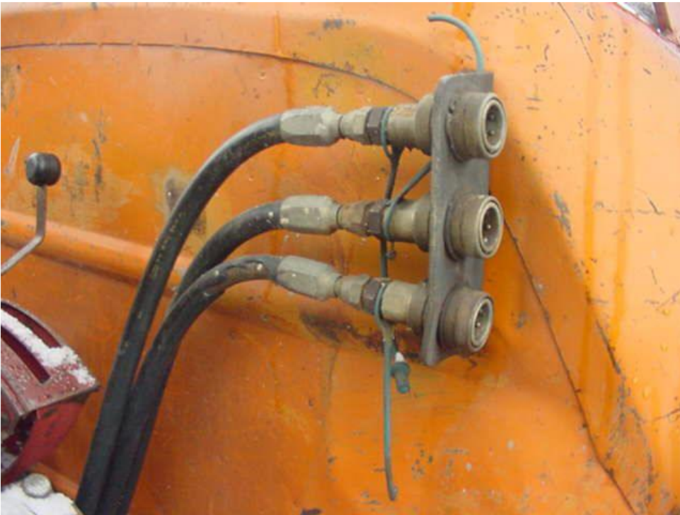
Fig. 15 - trattore con innesti rapidi non riconoscibili
