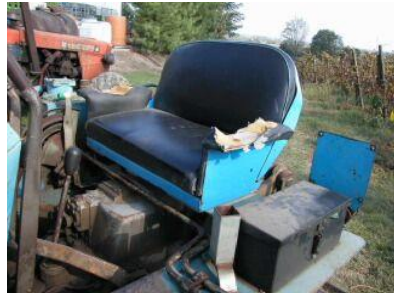
Figg. 66 e 67- sedili fissi senza attacchi per le cinture di sicurezza
