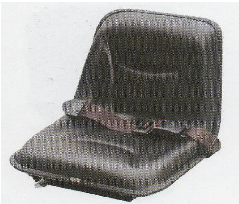
Fig. 68 - sostituzione con sedile fisso con cinture
