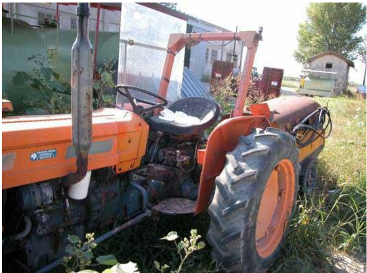
Fig. 98 - terminale di scarico non protetto
