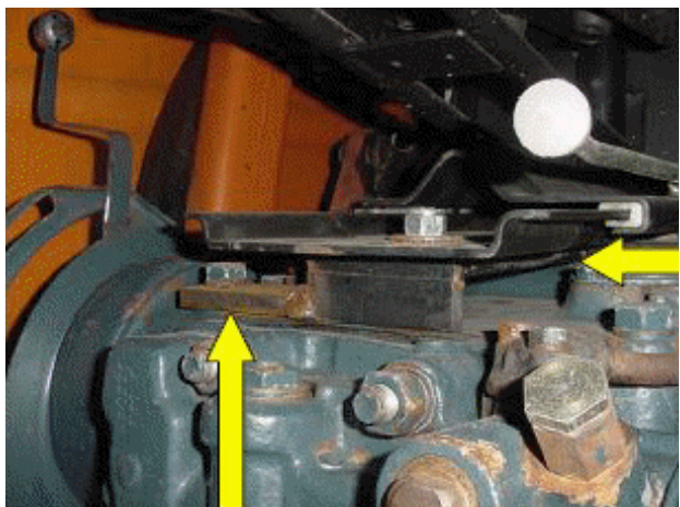
piastra di collegamento installata sul basamento della trattrice (mm 80x200x4)
