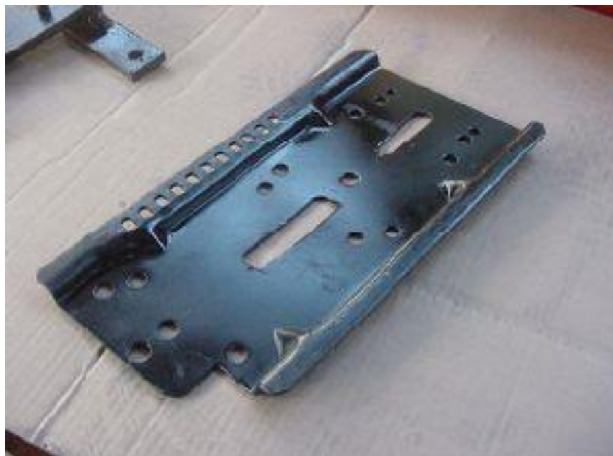
Fig. 81 B piastra per la regolazione orizzontale, fornita unitamente al sedile
