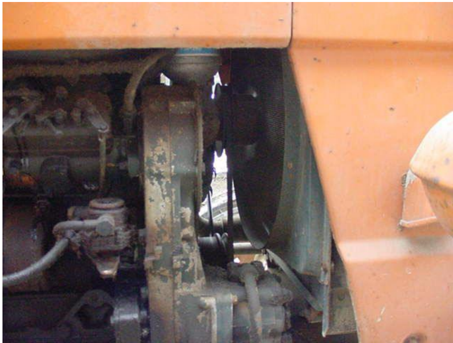
Fig. 10 - trattore sprovvista di protezioni delle cinghie puleggie e ventole, dall'origine
