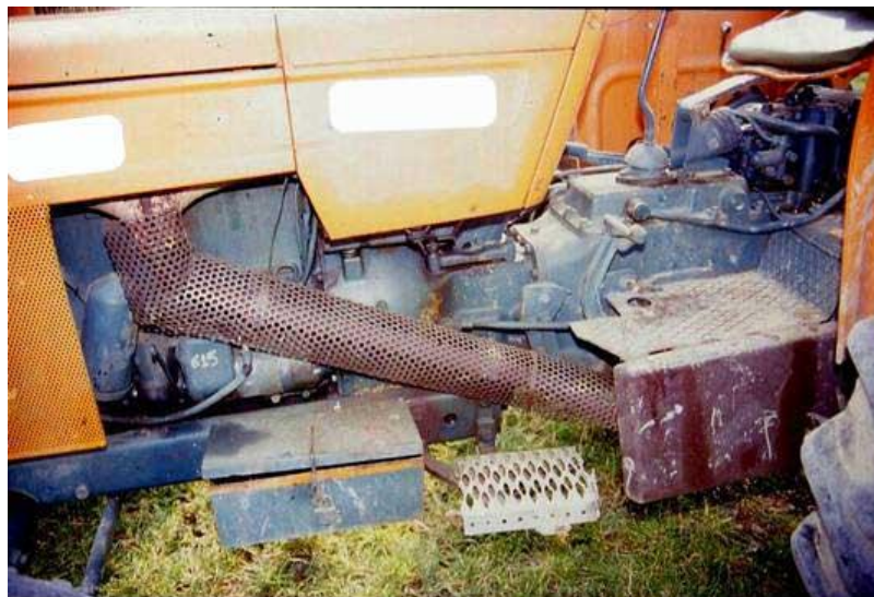
Fig. 99 - terminale di scarico protetto con intervento di miglioria
